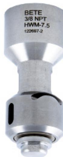
La buse de nettoyage de cuve HydroWhirl® Mini dirige l'eau de nettoyage à travers une tête rotative à l'extrémité de l'ensemble de pulvérisation et produit un jet mobile vigoureux sur toutes les zones de la paroi du réservoir.
