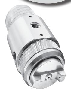
La buse SAM représente un nouveau niveau de contrôle de la pulvérisation. Avec trois entrées d'air, le cycle marche / arrêt, le niveau d'atomisation et la largeur du jet peuvent tous être réglés indépendamment. Cela donne un énorme degré de contrôle pour les systèmes de pulvérisation de précision.
