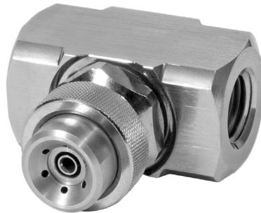
La buse à atomisation pneumatique XAER produit des pulvérisations finement atomisées en forme de cône complet. La conception du mélange externe signifie qu'elle peut traiter des fluides visqueux et que le contrôle des débits est plus simple qu'avec les variantes à mélange interne. Ces caractéristiques font que la XAER est le plus souvent utilisée pour :
